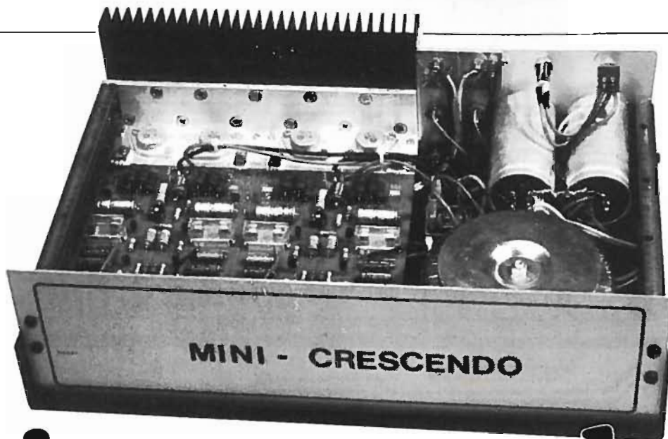
Figure 5. Vue plongeante dans les entrailles du mini-crescendo construit dans un boîtier de faible hauteur. Pour des raisons techniques (matériel d'exposition), la lampe de visualisation de mise sous tension et l'interrupteur marche/arrêt se trouvent à l'arrière de l'appareil.
